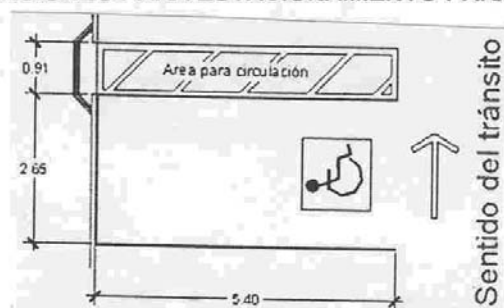
FIGURA 6. DIMENSIONES PARA ESTACIONAMIENTO PARA DISCAPACITADOS
