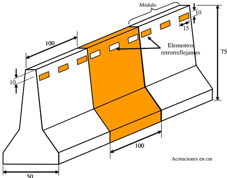
**FIGURA 2.- Colocación de las barreras fijas en serie**
